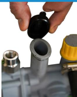
L'huile doit être visible dans l'orifice de remplissage après avoir ôté le bouchon
